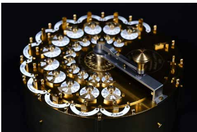
Die erste voll funktionierende Rechenmaschine der Welt von Philipp Matthäus Hahn. Nachbau von Leibfritz Konstruktion.
